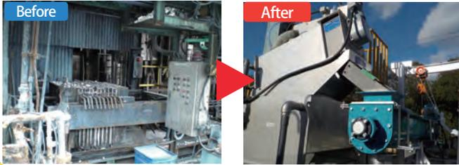
半自動式フィルタープレスからスクリーブレス (SUS製) へ更新
