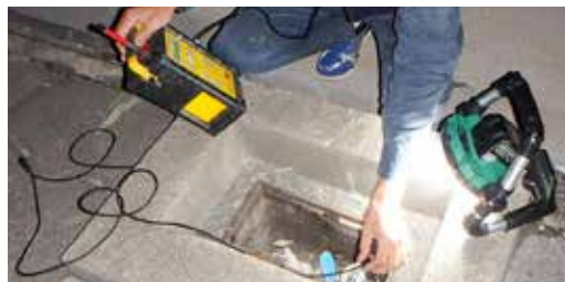
大きく反応があるところが漏水箇所です。
